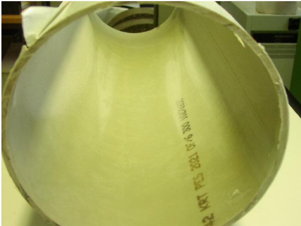
Abb. 5: Innenfläche des Rohres nach 200000 Lastspielen
